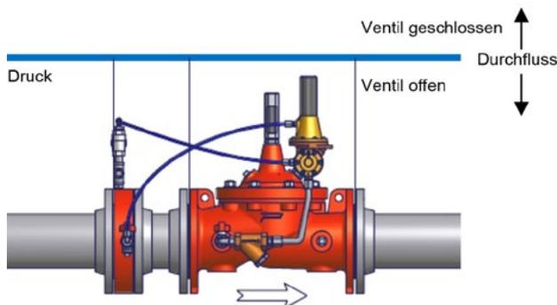
Das CLAYTON Rohrbruchsicherungsventil ist eingangsseitig mit einer Messblende ausgerüstet. Wenn der Durchfluss die vorgegebene Rohrbruchmenge und somit auch den vorgegebenen Differenzdruck erreicht, schließt sich das Ventil. Nachdem der Rohrbruch behoben wurde, muss das Rohrbruchsicherungsventil wieder in Betrieb genommen werden.
